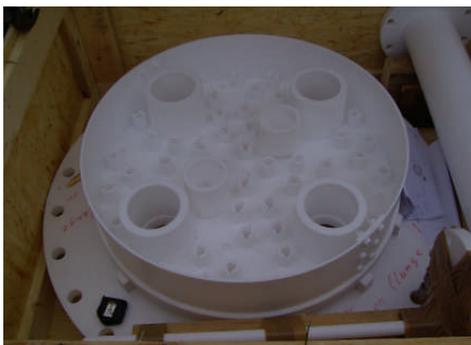
TYPICAL ARRANGEMENT OF OD10 LIQUID DISTRIBUTOR
